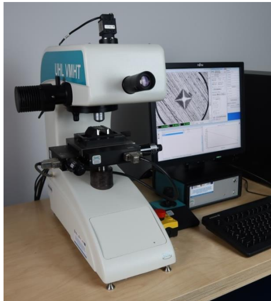
Rys. 38. Mikrotwardościomierz VMHT AUTO mot firmy UHL
