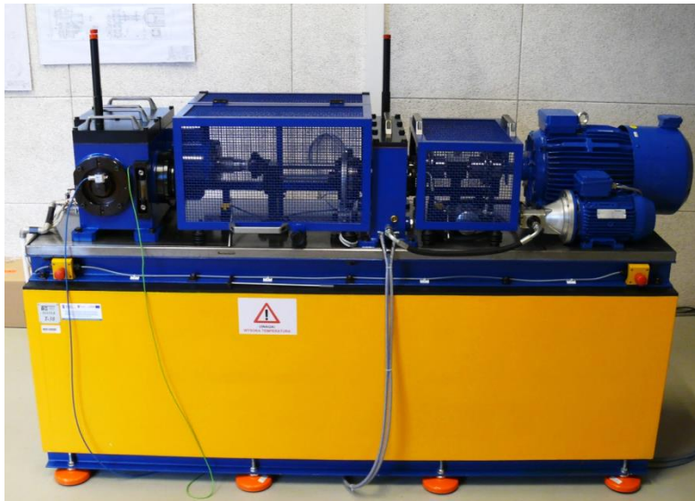
Rys. 24. Tester T-30 do kół zębatach stożkowych (ITeE-PIB w Radomiu)
