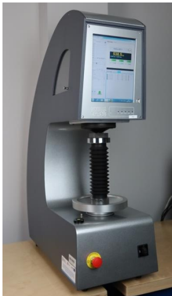
Rys. 37. Twardościomierz uniwersalny OMNITEST firmy ERNST
