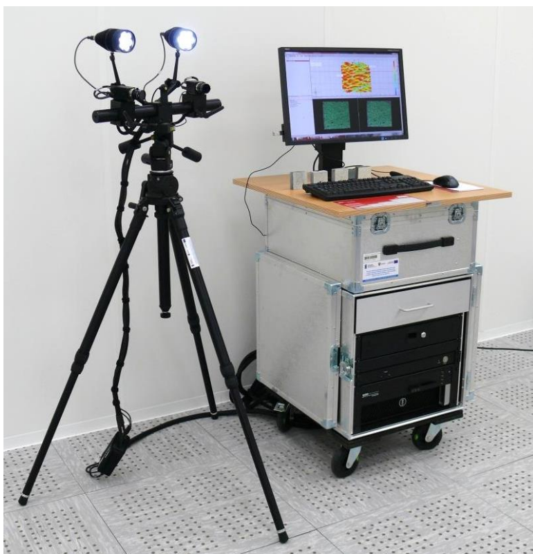
Rys. 33. 3D Aramis 5M firmy GOM GmbH
