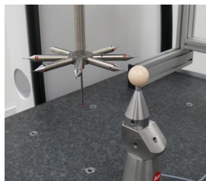
Rys. 11. Kalibracja na kuli wzorcowej
