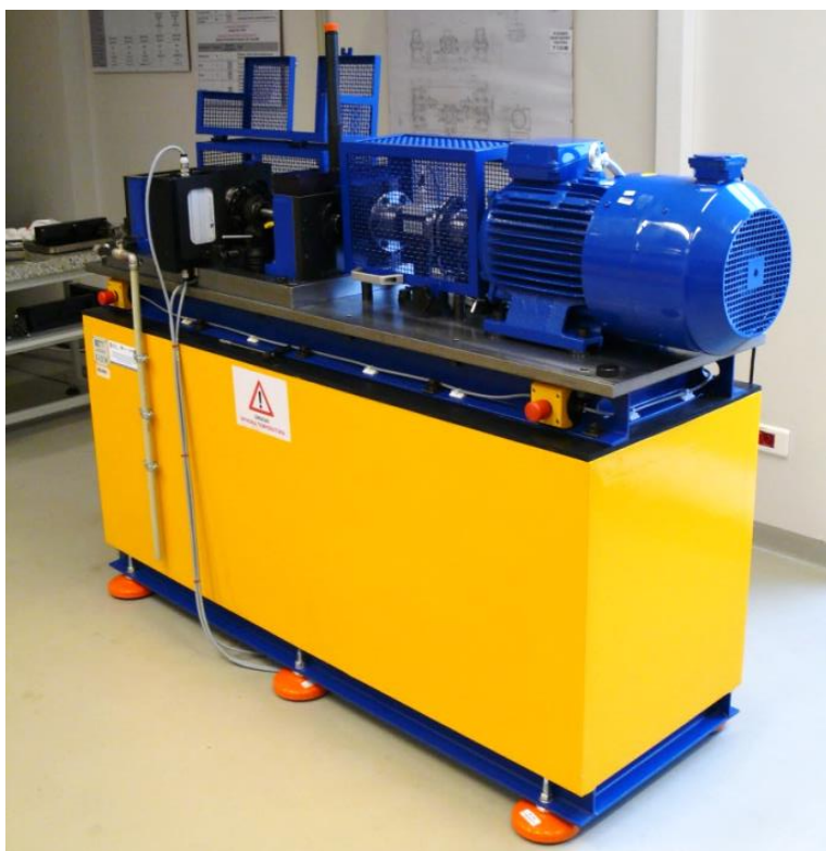
Rys. 17. Tester T-12UM do kół zębatach walcowych (ITeE-PIB w Radomiu)
