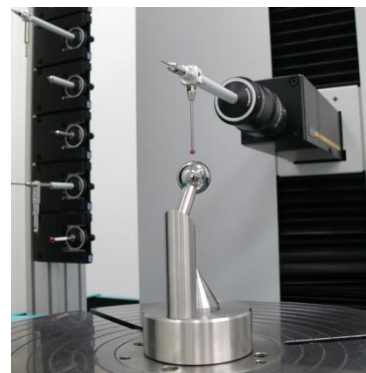
Rys. 22. Kalibracja na kuli wzorcowej
