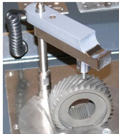
Rys. 40. Badanie składu chemicznego materiału koła zębatego walcowego
