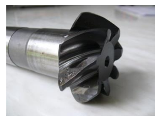
Rys. 26. Pitting i inne formy zużycia na zębniku (koło zębate stożkowe)
