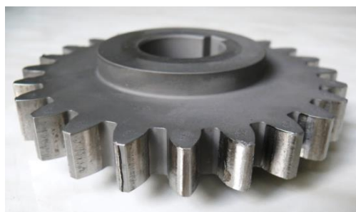
Rys. 28. Ślady zużycia koła zębatego walcowego o zębatach prostych po teście wytrzymałościowym
