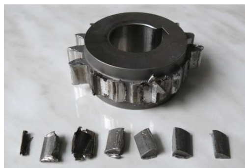
Rys. 29. Wylamane zęby koła zębatego walcowego o zębatach prostych po teście wytrzymałościowym
