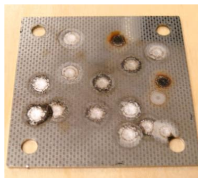
Rys. 41. Ślady powstałe po badaniu składu chemicznego blachy
