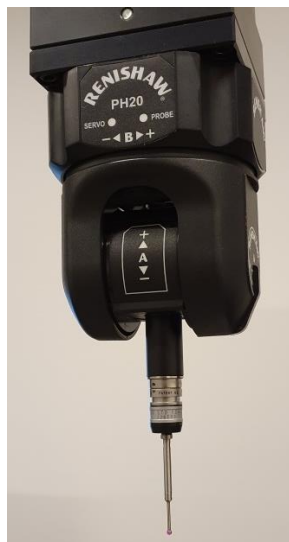
Rys. 8. Głowica pomiarowa RENISHAW PH20
