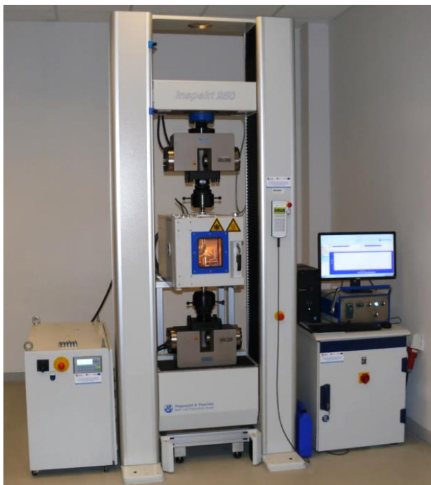
Rys. 30. Maszyna wytrzymałościowa Inspekt 250kN firmy Hegewald & Peschke GmbH
