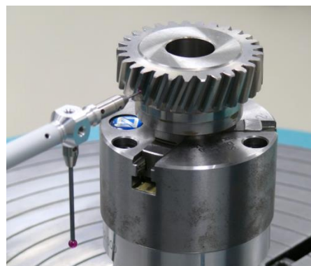
Rys. 23. Pomiar koła zębatego
