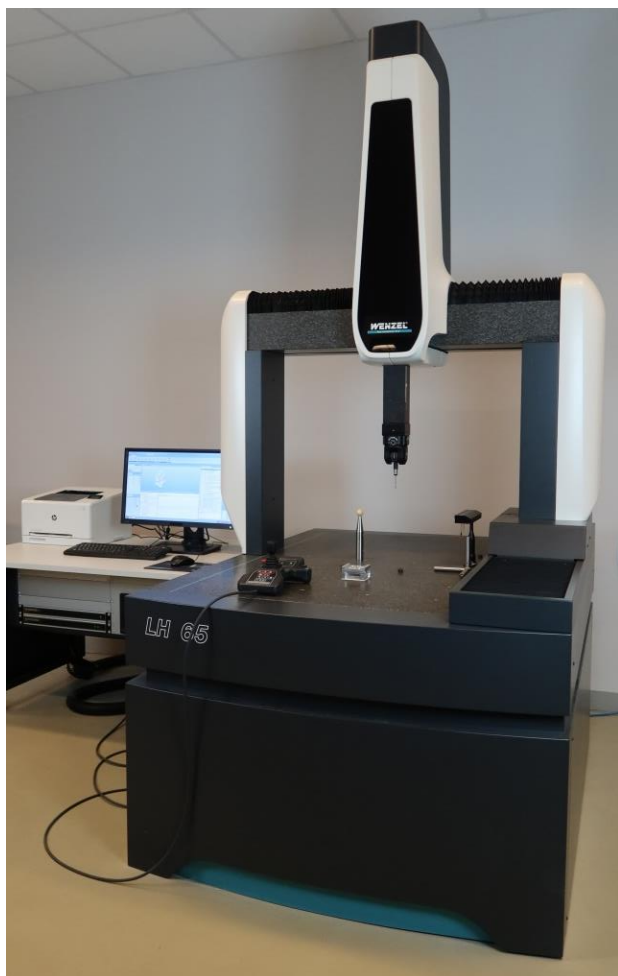
Rys. 7. Współrzędnościowa maszyna pomiarowa Wenzel LH 65
