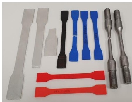
Rys. 32. Przykładowe próbki do statycznej próby rozciągania
