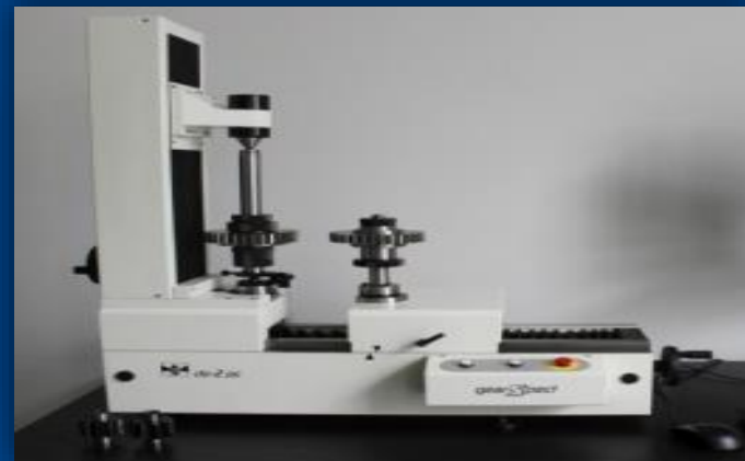
do-2 pc: Urządzenie do badania współpracy jednostronnej kół zębatych
